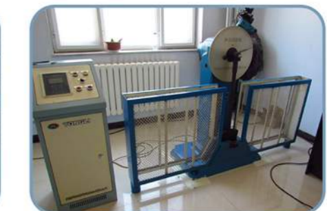
冲击试验 Impact Test
